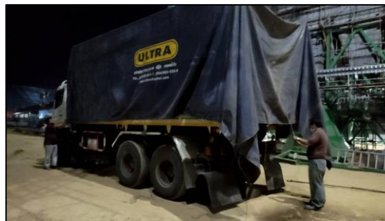
รูปที่ 2-5 การปิดคลุมกระบะท้ายรถบรรทุก
